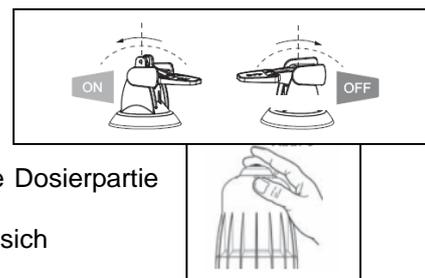
**ANMERKUNG:** Die Ansaugzeit für das Konzentrat hängt vom Durchsatz, der Einstellung der Dosierung und der Länge des Ansaugschlauches ab. Zur Beschleunigung des Ansaugvorgangs die maximale Dosierung einstellen. Bei Erreichen der Dosierpartie den gewünschten Wert einstellen.
