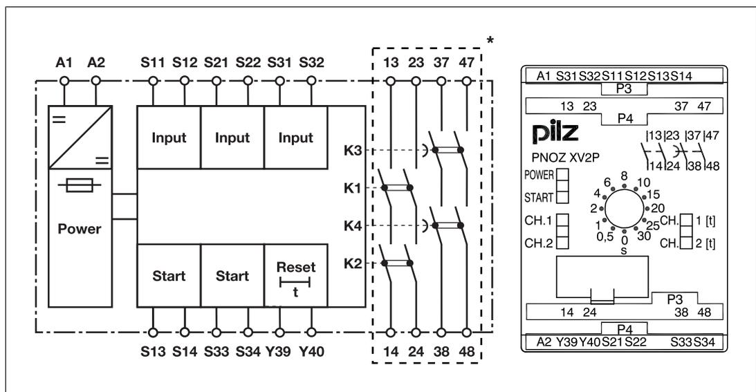
\*Isolation zum nicht markierten Bereich und der Relaiskontakte zueinander: Basisisolierung (Überspannungskategorie III), sichere Trennung (Überspannungskategorie II)
