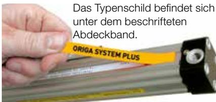
Das Typenschild befindet sich unter dem beschrifteten Abdeckband.
